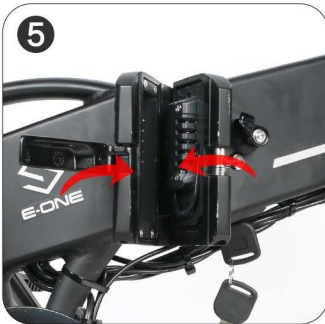
Introduceți cheia în orificiul pentru cheie, rotiți-o în sensul acelor de ceasornic pentru a bloca bateria, apoi pliați cadrul
