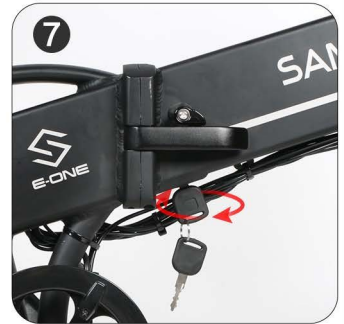
Când doriți să scoateți bateria, trebuie să o deblocați mai întâi în conformitate cu direcția. Când vehiculul este pornit, trebuie să rotiți cele două roți dințate în sens invers acelor de ceasornic pentru a debloca
