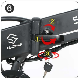
După ce cadrul este pliat și închis, catarama de blocare în mod corespunzător, rotiți cheia în direcția de pornire a bateriei și porniți-o. (Rotirea cheii are două viteze, prima viteză blochează bateria, iar a doua viteză energizează ebike)
