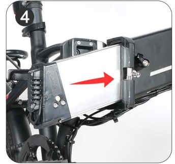
Introduceți bateria în compartimentul pentru bateria cu polul negativ în partea de sus și polul pozitiv în partea de jos.
